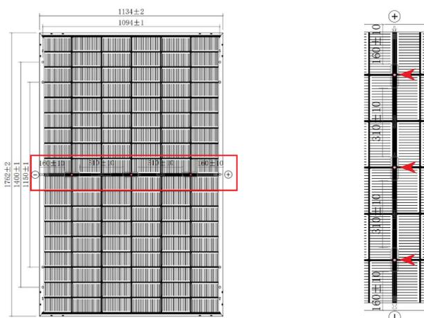
Abbildung 4: Anordnung Anschlussdosen am Beispiel von ZEUS 1.0
