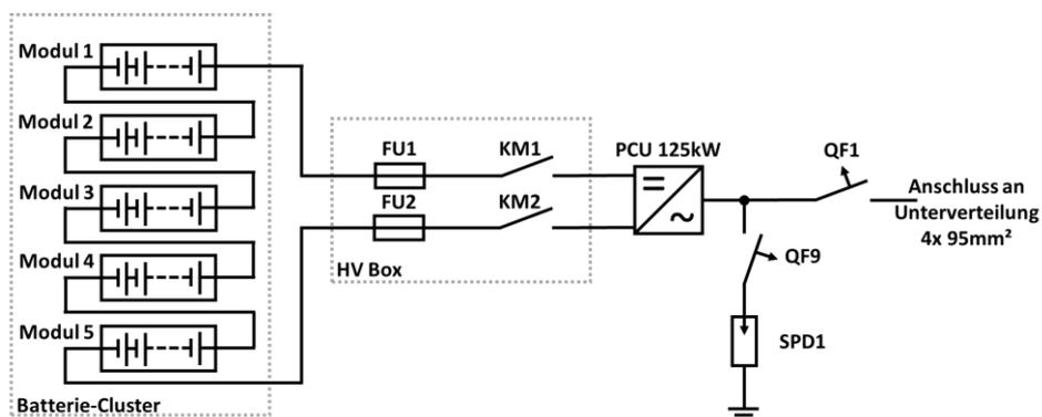
Abbildung 13: Schematische Darstellung des Hauptstromkreises
