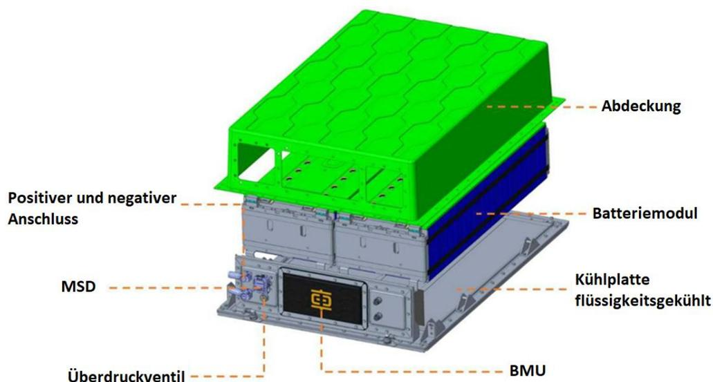
Abbildung 4: Explosionszeichnung des Batteriemoduls
