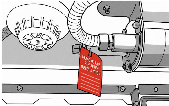
Abbildung 17: Warnschild für das Entfernen des Sicherungspins
